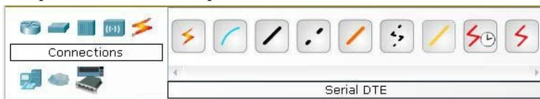
Рис. 1.3. Поддерживаемые в Packet Tracer типы кабелей.
